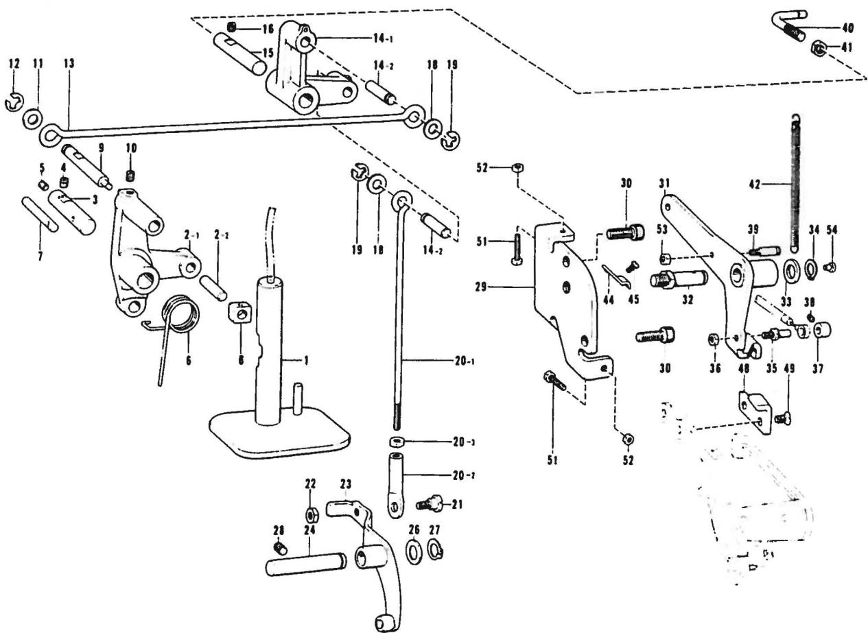
**K. Thread wiper mechanism / Fadenwischvorrichtung
